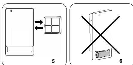
**Filter** - Das Gerät verfügt über einen Filter, um das Heizelement vor Staub und Schmutz zu schützen. Dieser herausnehmbare Filter ist mit Wasser leicht zu reinigen. (**Bild 5**) Der Filter sollte alle 6 Monate gereinigt werden. Das Gerät niemals ohne diesen Filter betreiben!
