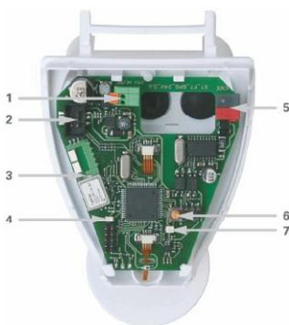
1. Federklemmen zur 12 bis 40 VDC TBTS / 12 bis 24 VAC-Speisung, für massive Leiter bis 1,5 mm<sup>2</sup> Querschnitt oder für flexible Leiter. Klemmenbelegung polungsunabhängig (+/- oder -/+)
