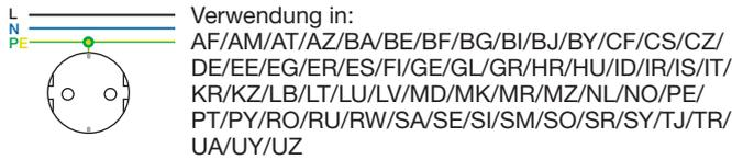
**Bild 1:** Steckdose SCHUKO\* – 2-polig + Erde, 250 V~, 16 A
