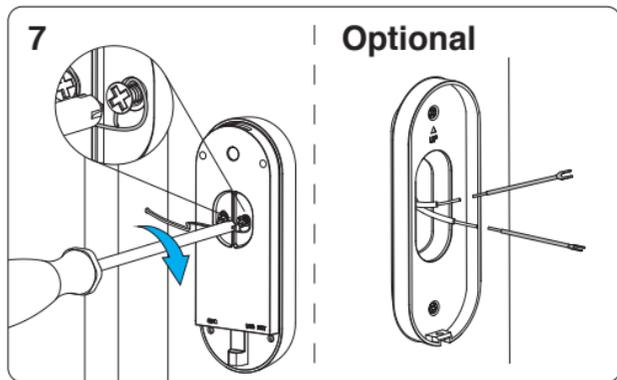
**NL** Verbind de bedraad uit de muur met de schroefjes aan de achterzijde van de SMART-RING20. Links of rechts maakt niet uit. Draai de schroeven weer vast. Optioneel: Indien de bedraad uit de muur te kort is, kun je gebruik maken van de draadverlengers. Soldeer deze vast aan de bedraad en isoleer de draad met krimpkous of isolatietape.
