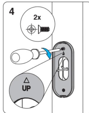
**NL** Plaats de bevestigingsplaat met 'UP' aan de bovenzijde op de hoekwandbevestiging.
