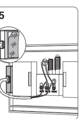
**NL** Maak de 'mechanical chime' met de 3M tape vast in of buiten de behuizing van de bestaande bel.
