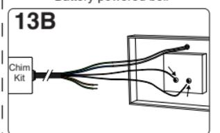
**NL** Verbind de gele en oranje draad van de Chime Kit met de aansluitingen op uw bel.
