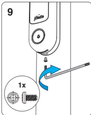
**NL** Draai het borgschroefje met behulp van de inbussleutel tool vast in de onderkant van de SMART-RING20.
