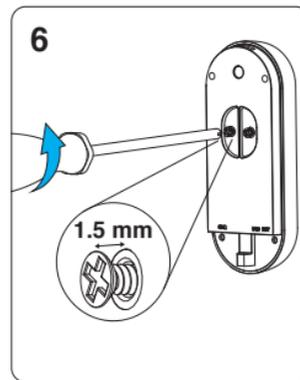
**NL** Draai de schroefjes aan de achterzijde van de SMART-RING20 2 slagen los (±1,5 mm).
